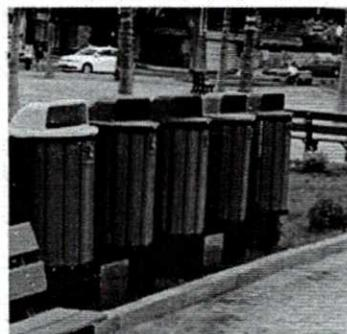
Tampa para lixeira em madeira plástica, fabricada através de polipropileno injetado. A tampa possui abertura frontal medindo 110x390mm, com opção nas cores preta, verde - vidro, vermelho - plástico, azul - papel, marrom - orgânico, amarelo - metal. Entregue em um kit contendo: 1 tampa. Observação: Descrição básica do produto que, segundo especificações, pode atender critérios de similaridade ou equivalência.
